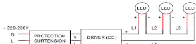
La tension consommée par un luminaire est égale à sa puissance divisée par son intensité (ex. : 1,5W / 0,35A = 4,3V).
