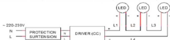
La tension consommée par un luminaire est égale à sa puissance divisée par son intensité (ex. : 1,5W / 0,35A = 4,3V).
